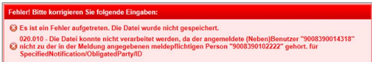
Abbildung 5 Fehlermeldung: MUSS-Prüfregel verletzt
